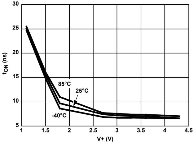
FIGURE 15. TURN-ON TIME vs SUPPLY VOLTAGE
