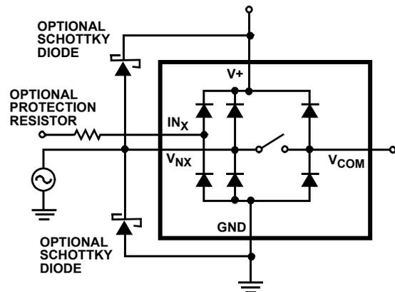
FIGURE 8. OVERVOLTAGE PROTECTION
