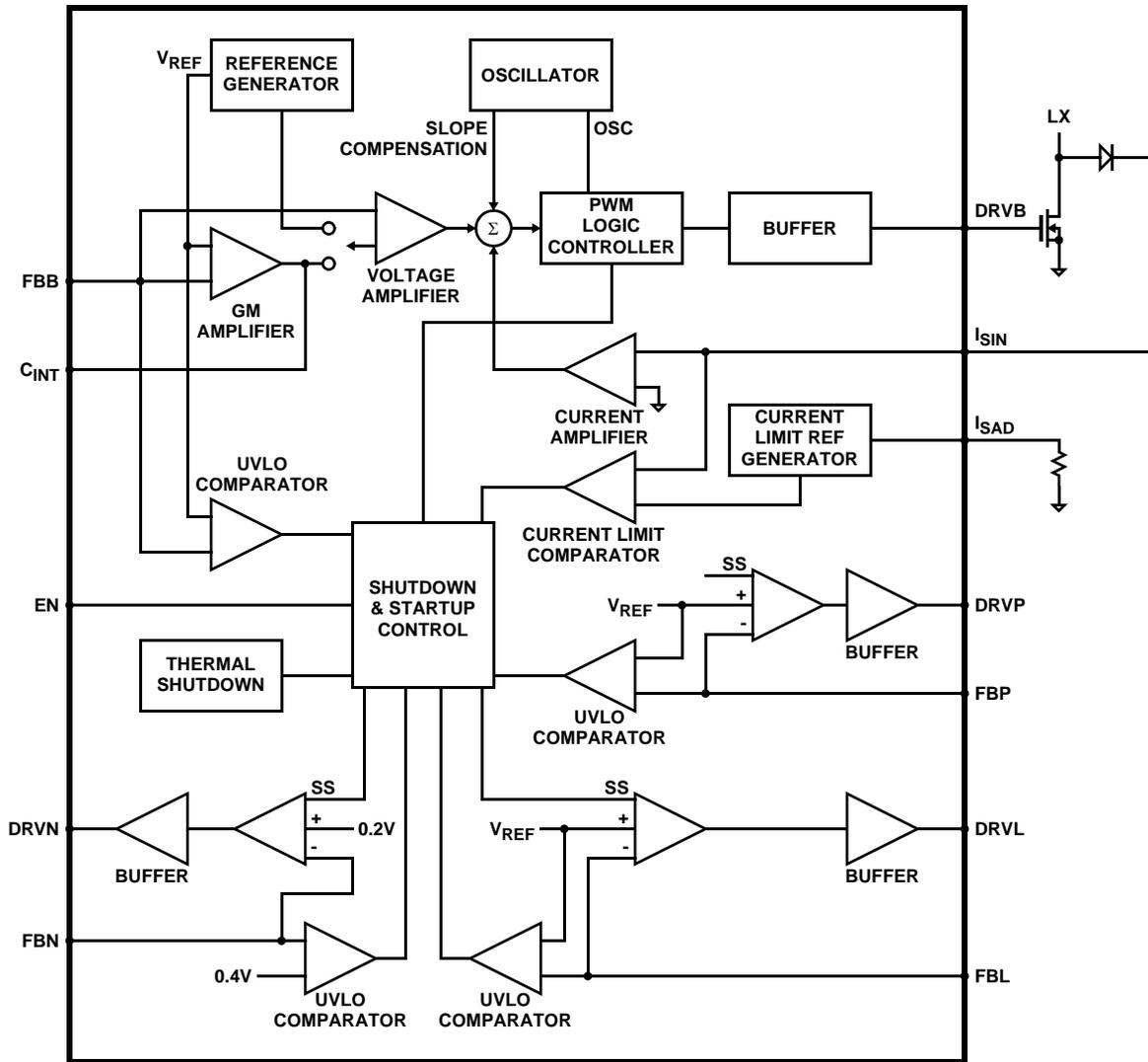
FIGURE 24. BLOCK DIAGRAM
