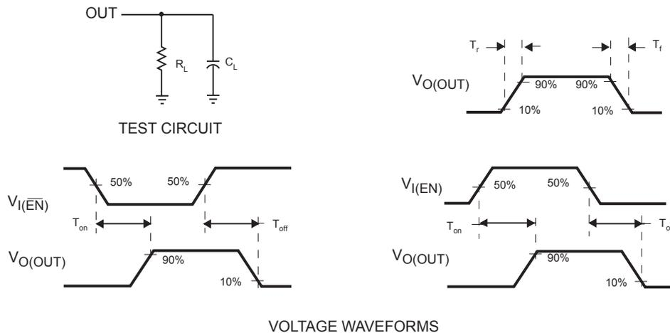
**Figure 1—Definition of  $T_r$ ,  $T_f$ ,  $T_{on}$ , and  $T_{off}$**
