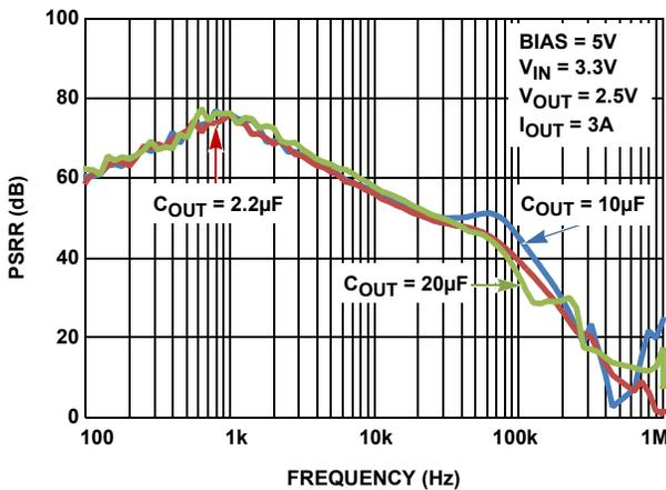
FIGURE 32.  $V_{\text{IN}}$  PSRR vs FREQUENCY FOR VARIOUS  $C_{\text{OUT}}$
