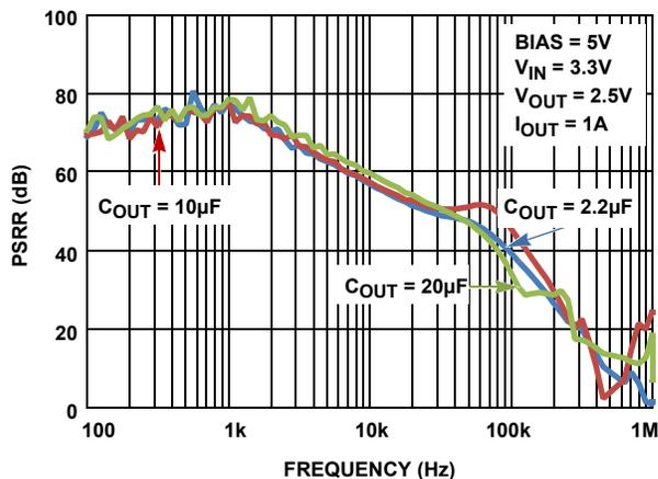
FIGURE 33.  $V_{\text{IN}}$  PSRR vs FREQUENCY FOR VARIOUS  $C_{\text{OUT}}$
