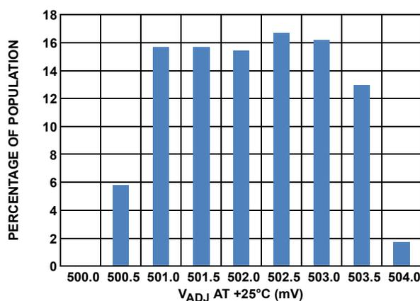
FIGURE 7.  $V_{ADJ}$  DISTRIBUTION
