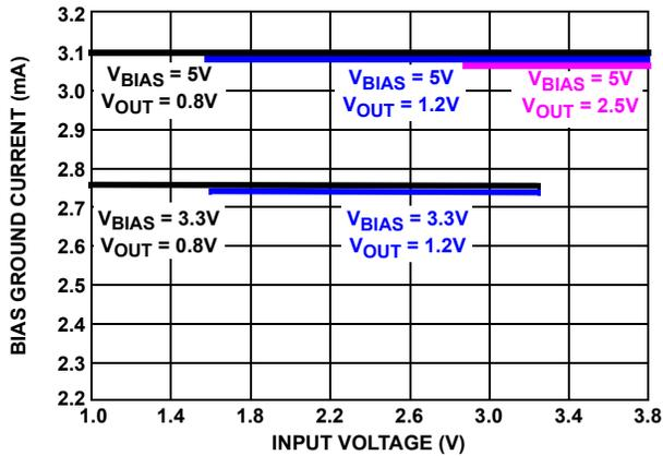
FIGURE 16. BIAS GROUND CURRENT vs  $V_{\text{IN}}$  and  $V_{\text{OUT}}$
