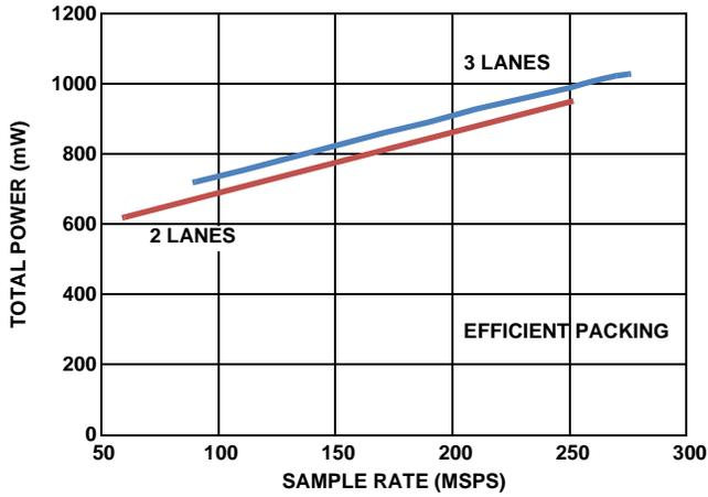
FIGURE 9. POWER vs f<sub>SAMPLE</sub>
