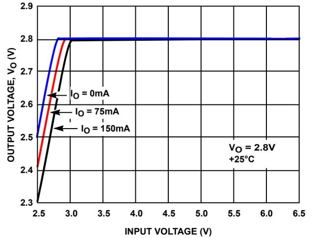
FIGURE 6. DROPOUT VOLTAGE vs INPUT VOLTAGE (2.8V OUTPUT)
