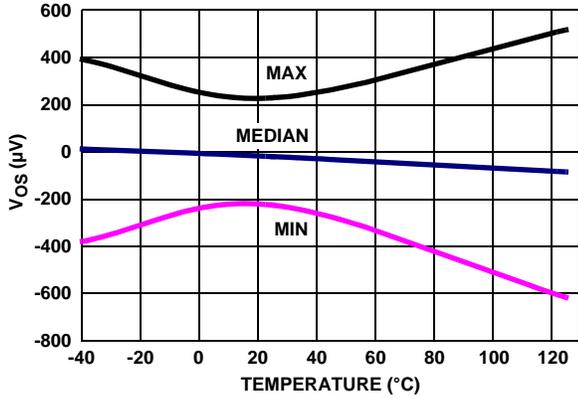
FIGURE 24.  $V_{OS}$  (SOIC PKG) vs TEMPERATURE
