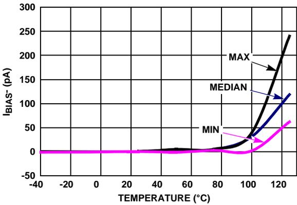
FIGURE 28.  $I_{BIAS-}$  vs TEMPERATURE  $V_+, V_- = \pm 2.5V$
