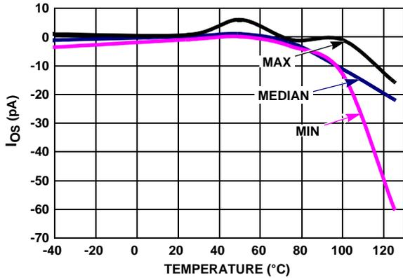
FIGURE 30.  $I_{OS}$  vs TEMPERATURE  $V_+, V_- = \pm 2.5V$
