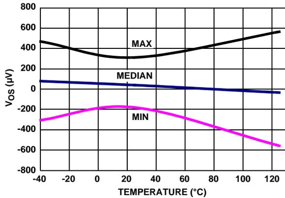
FIGURE 26.  $V_{OS}$  (SOIC PKG) vs TEMPERATURE
