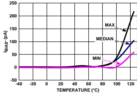
FIGURE 29.  $I_{BIAS-}$  vs TEMPERATURE  $V_+, V_- = \pm 1.2V$
