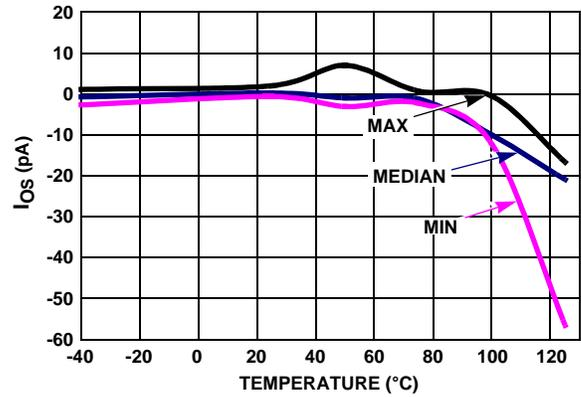
FIGURE 31.  $I_{OS}$  vs TEMPERATURE  $V_+, V_- = \pm 1.2V$
