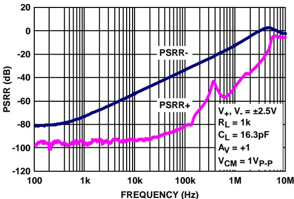
FIGURE 11. PSRR vs FREQUENCY,  $V_+$ ,  $V_- = \pm 2.5V$
