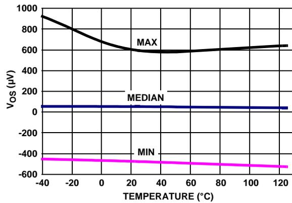
FIGURE 27.  $V_{OS}$  (SOT PKG) vs TEMPERATURE
