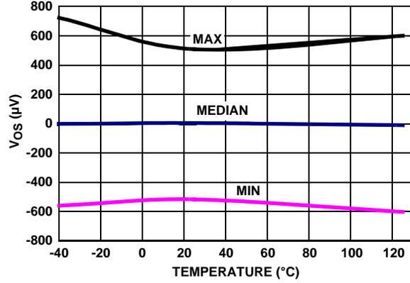
FIGURE 25.  $V_{OS}$  (SOT PKG) vs TEMPERATURE
