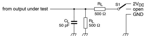
**Figure 22. Load Circuit**
