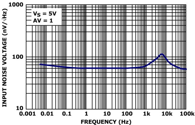
FIGURE 11. INPUT NOISE VOLTAGE DENSITY vs FREQUENCY
