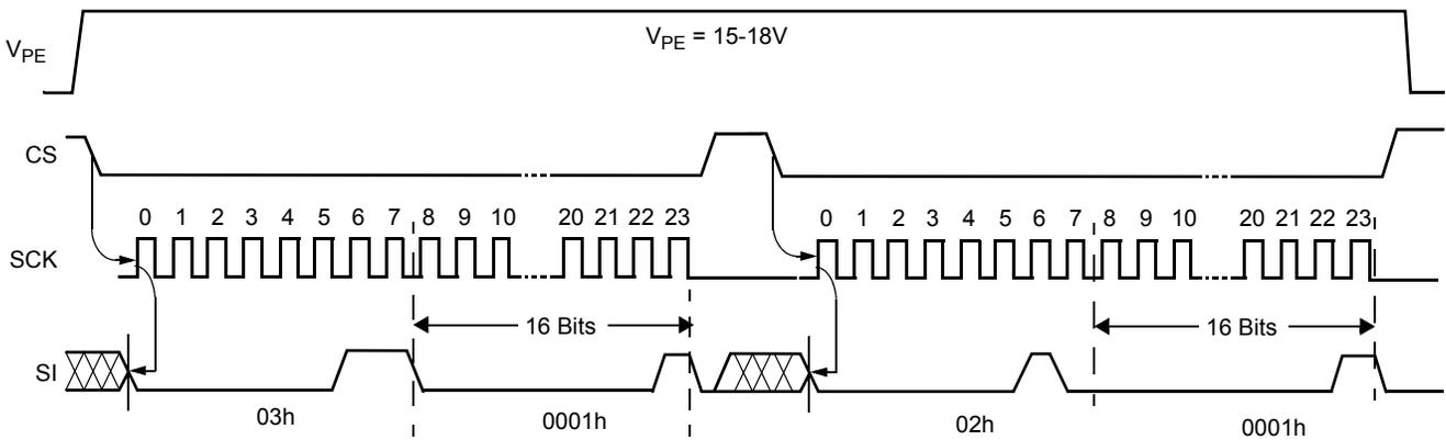
Figure 3. Reset  $V_{TRIP}$  Level Sequence ( $V_{CC} > 3V$ )
