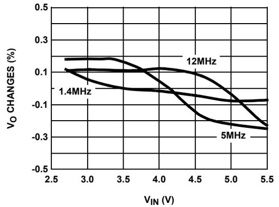
**FIGURE 21. LINE REGULATION @ 500mA (PWM MODE)**
