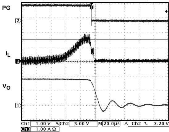
FIGURE 28. OVERCURRENT SHUTDOWN
