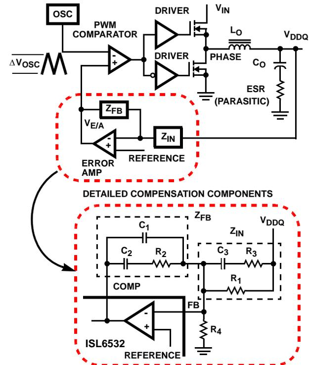
$$V_{DDQ} = 0.8 \times \left( 1 + \frac{R_1}{R_4} \right)$$
