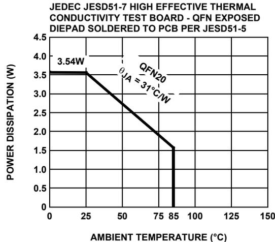
FIGURE 33. PACKAGE POWER DISSIPATION vs AMBIENT TEMPERATURE
