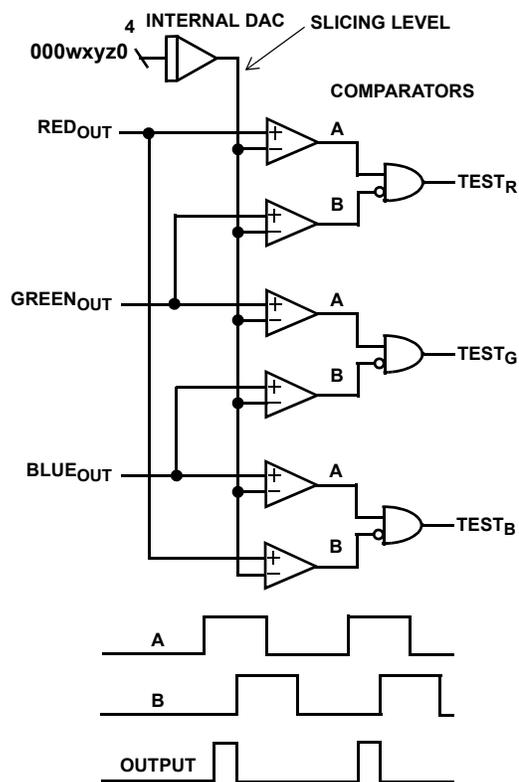
FIGURE 36. DELAY DETECTOR
