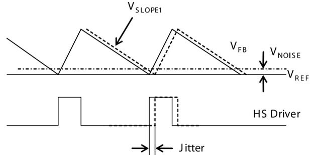
**Figure 4: PWM-Mode Jitter**
