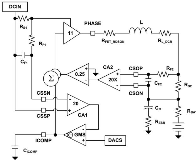
FIGURE 29. ADAPTER CURRENT LIMIT LOOP
