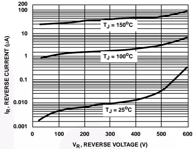
FIGURE 2. REVERSE VOLTAGE vs REVERSE CURRENT CHARACTERISTIC
