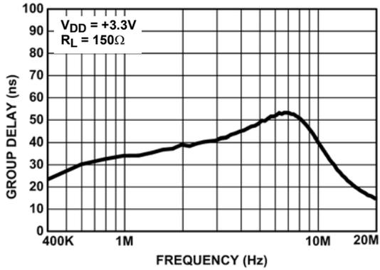
FIGURE 17. GROUP DELAY vs FREQUENCY
