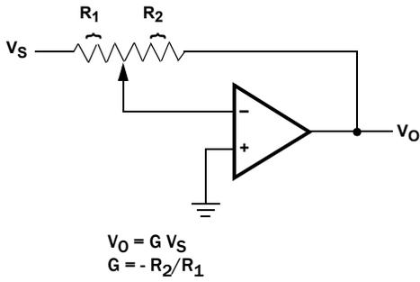
FIGURE 20. INVERTING AMPLIFIER
