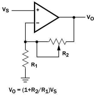
FIGURE 14. NONINVERTING AMPLIFIER
