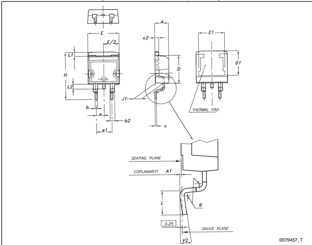
Figure 22. D<sup>2</sup>PAK footprint<sup>(a)</sup>
