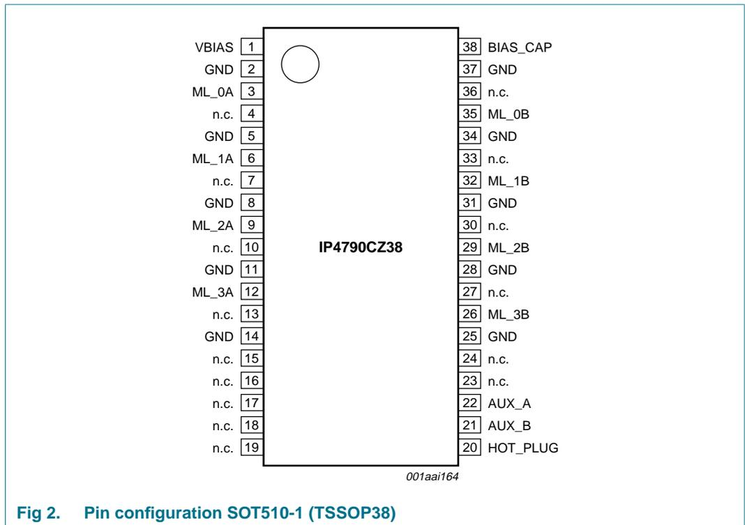
Fig 2. Pin configuration SOT510-1 (TSSOP38)
