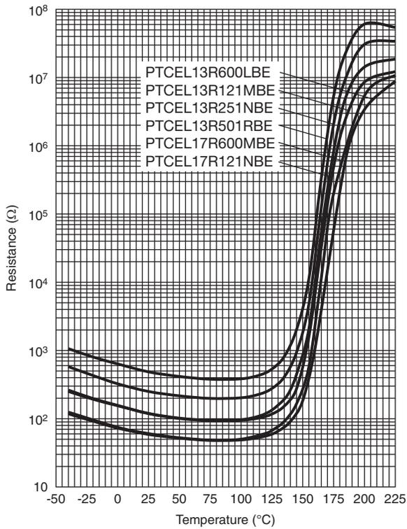
MINIMUM PTC RESISTANCE UNDER PULSED VOLTAGE
