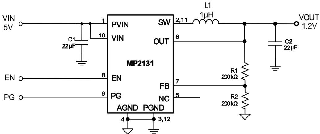
**Figure 6—5V<sub>IN</sub>, 1.2 V/4 A**
