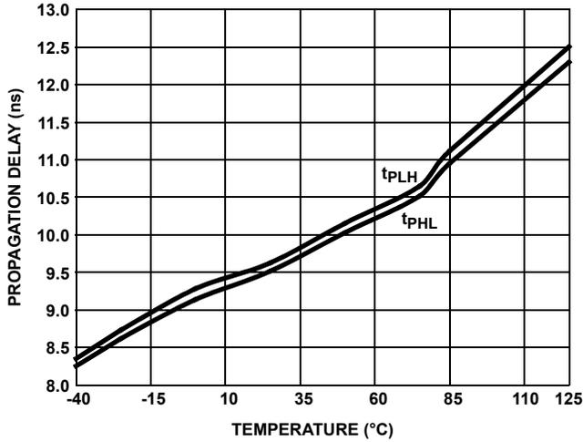
FIGURE 14. DRIVER DIFFERENTIAL PROPAGATION DELAY vs TEMPERATURE
