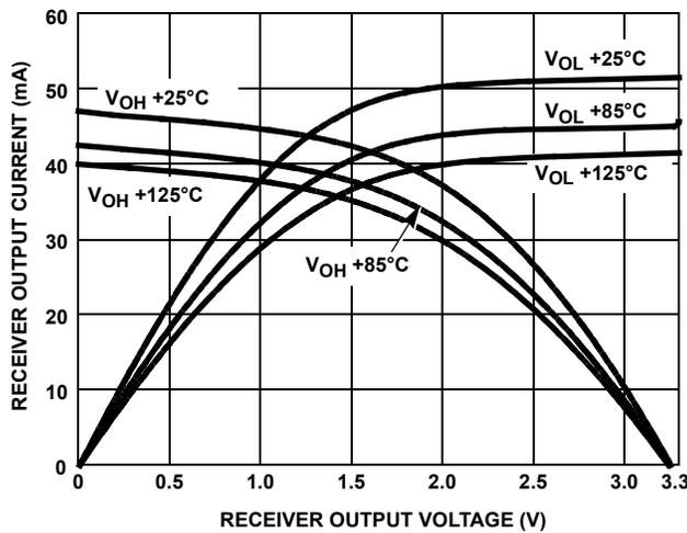
FIGURE 20. RECEIVER OUTPUT CURRENT vs RECEIVER OUTPUT VOLTAGE
