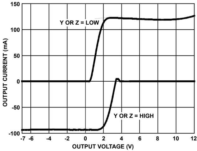
FIGURE 12. DRIVER OUTPUT CURRENT vs SHORT-CIRCUIT VOLTAGE
