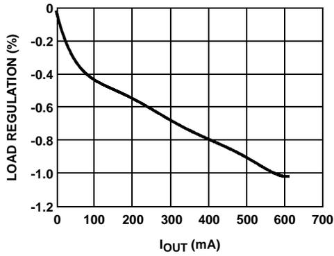
FIGURE 13. V<sub>LOGIC</sub> LOAD REGULATION
