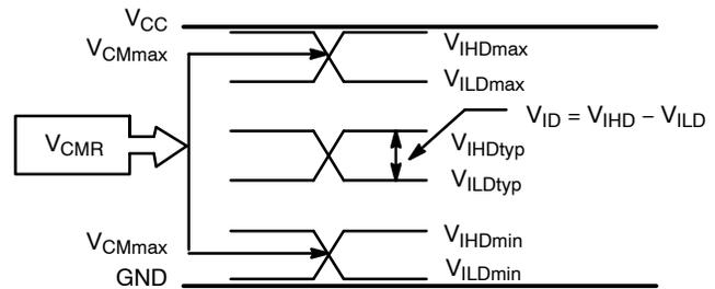
Figure 18.  $V_{CMR}$  Diagram
