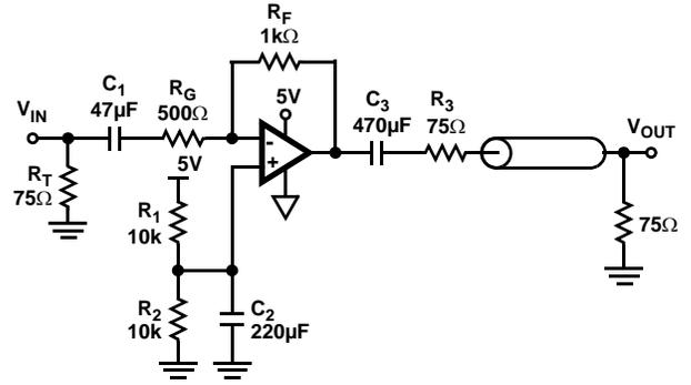
FIGURE 35. SINGLE SUPPLY INVERTING VIDEO LINE DRIVER
