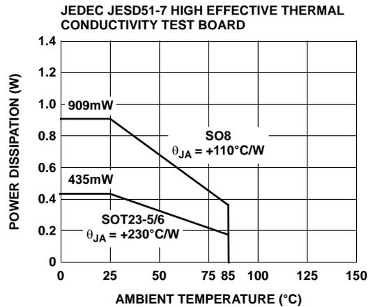
FIGURE 28. PACKAGE POWER DISSIPATION vs AMBIENT TEMPERATURE
