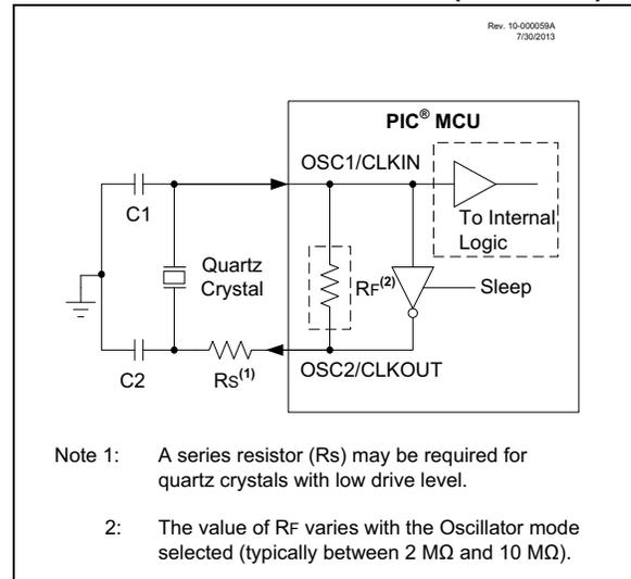
**FIGURE 5-4: CERAMIC RESONATOR OPERATION (HS MODE)**
