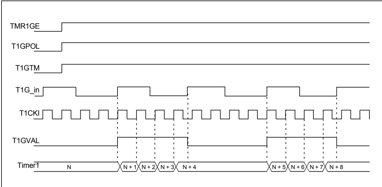
FIGURE 22-5: TIMER1 GATE SINGLE-PULSE MODE
