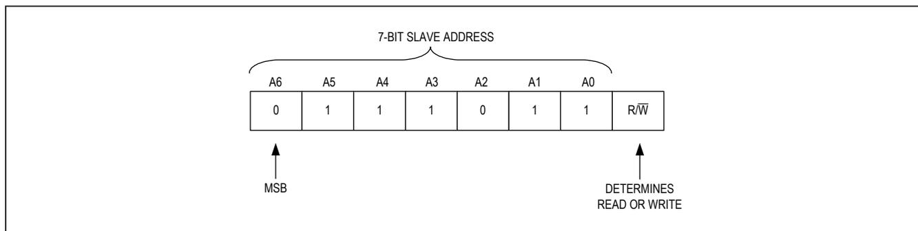
Figure 42. DS2476 I<sup>2</sup>C Slave Address
