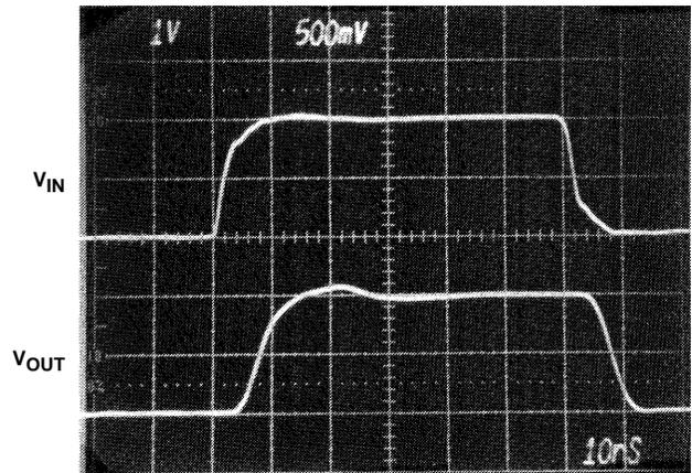
FIGURE 3. COAXIAL CABLE DRIVER - 50Ω SYSTEM
