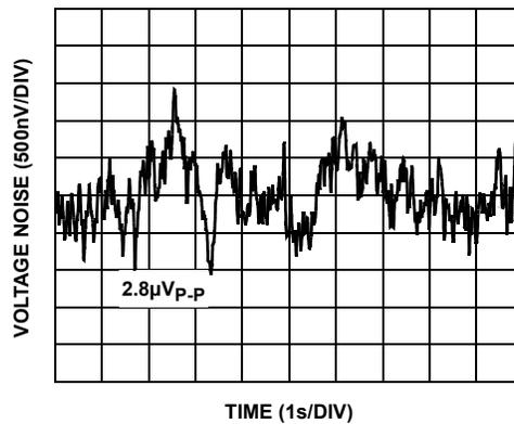
FIGURE 11. 0.1Hz TO 10Hz INPUT VOLTAGE NOISE
