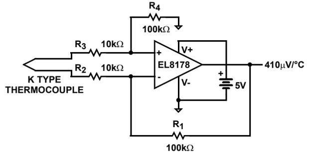
**FIGURE 30. THERMOCOUPLE AMPLIFIER**
