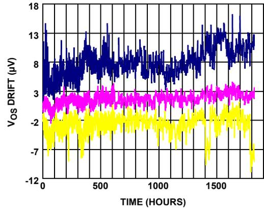
FIGURE 13. VOS DRIFT (SOIC PACKAGE) vs TIME
