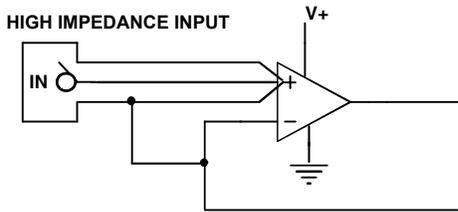
**FIGURE 28. GUARD RING EXAMPLE FOR UNITY GAIN AMPLIFIER**
