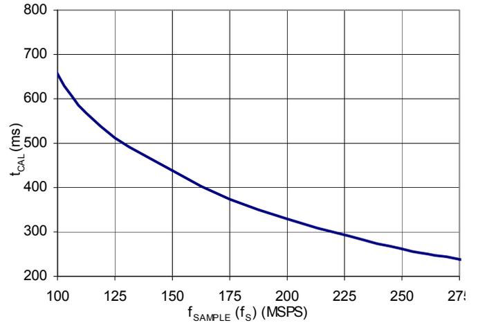
FIGURE 20. CALIBRATION TIME vs f<sub>S</sub>
