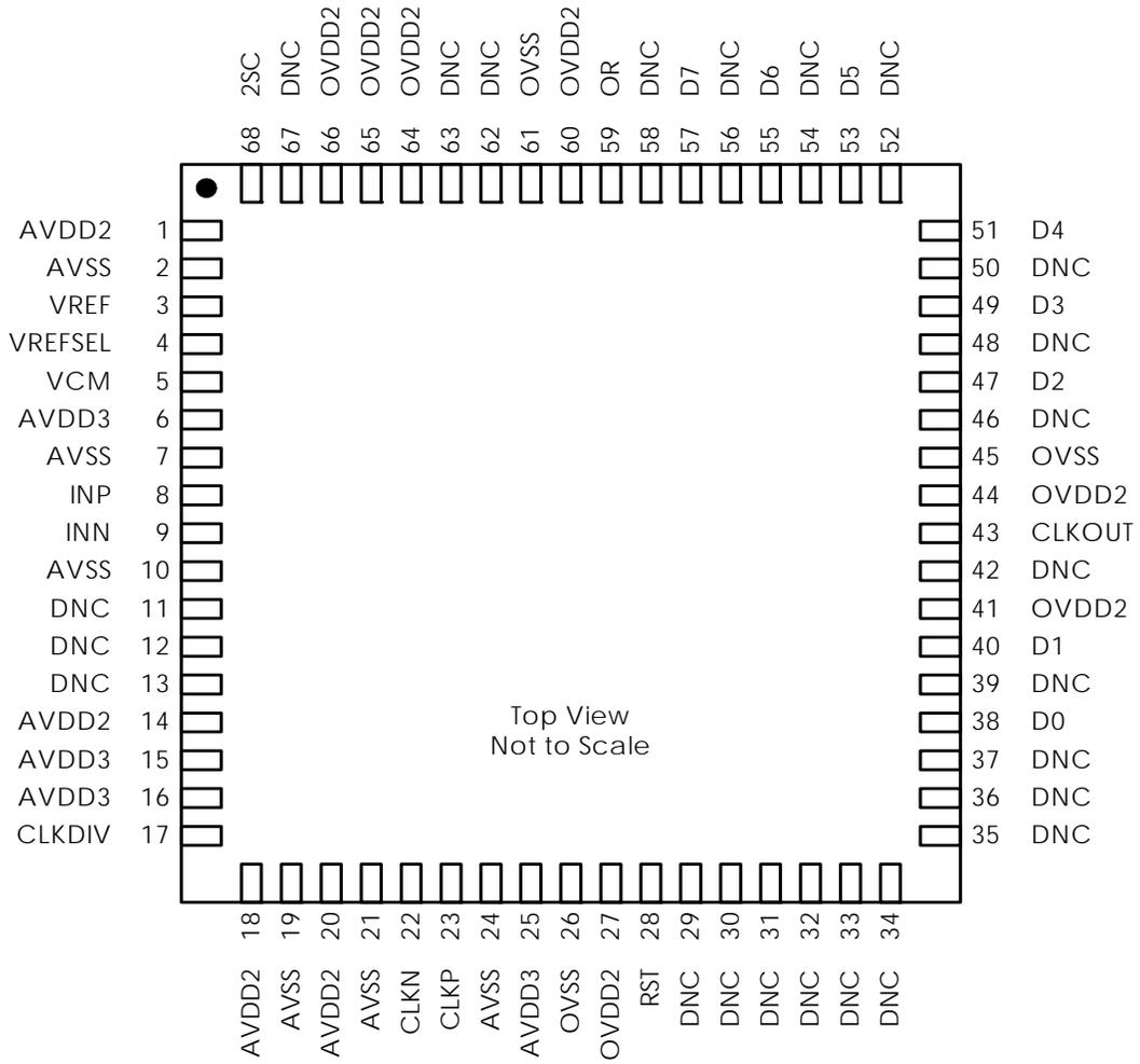
FIGURE 2. PIN CONFIGURATION
