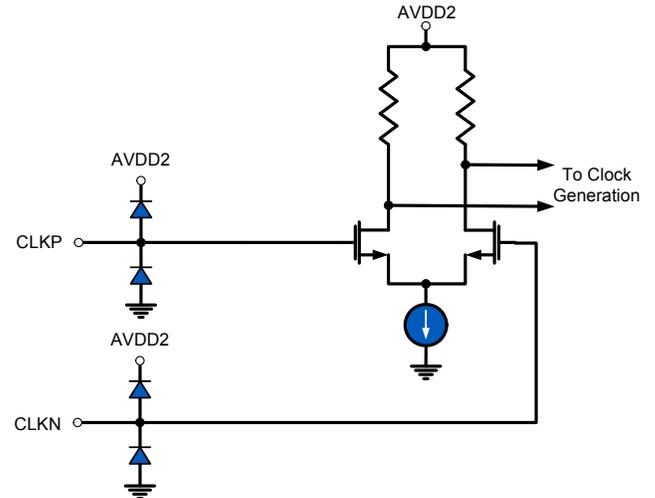
FIGURE 29. CLOCK INPUTS
