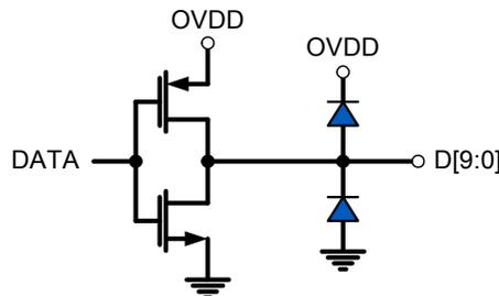
FIGURE 30. LVCMOS OUTPUT
