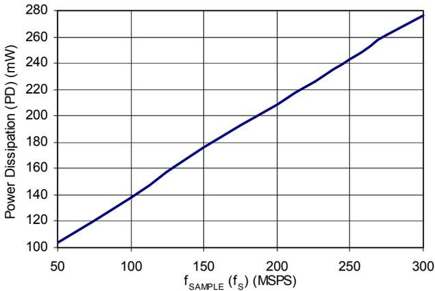
FIGURE 9. POWER DISSIPATION vs f<sub>SAMPLE</sub>
