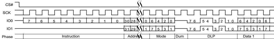
Figure 18. DDR Quad I/O Read
