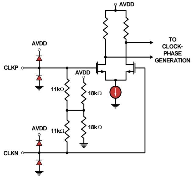
FIGURE 44. CLOCK INPUTS
