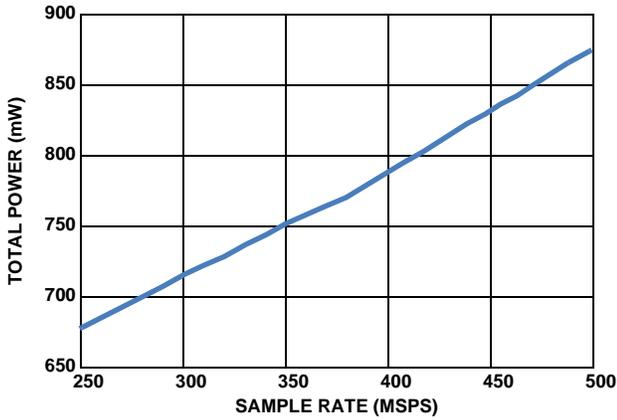
FIGURE 8. POWER vs f<sub>SAMPLE</sub> IN 3mA LVDS MODE
