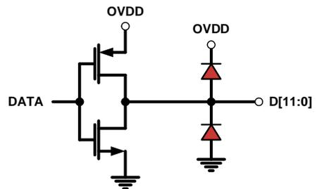
FIGURE 48. CMOS OUTPUTS
