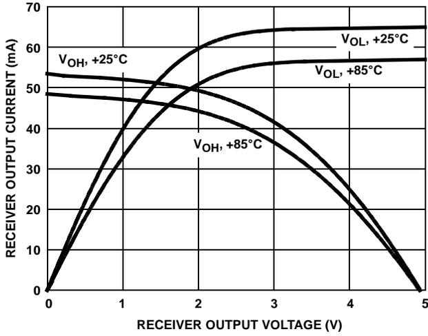
FIGURE 18. RECEIVER OUTPUT CURRENT vs RECEIVER OUTPUT VOLTAGE
