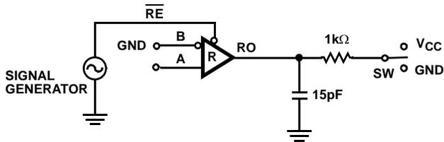
FIGURE 6A. TEST CIRCUIT
